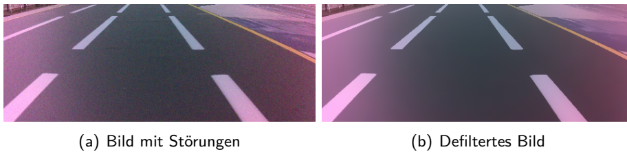
Abb. 4.3: Durch bilaterales Filtern verbessertes Bild
