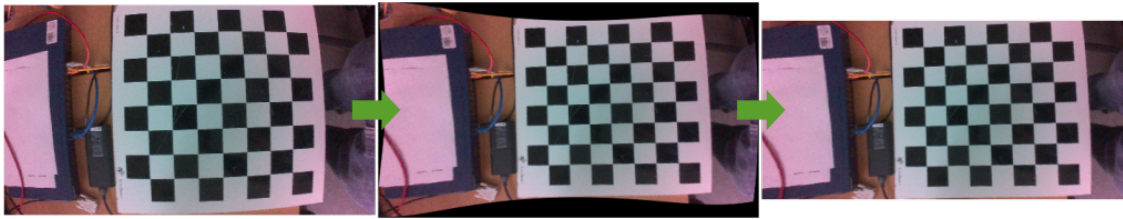
Abb. 3.5: Schritte der intrinsischen Kalibrierung
